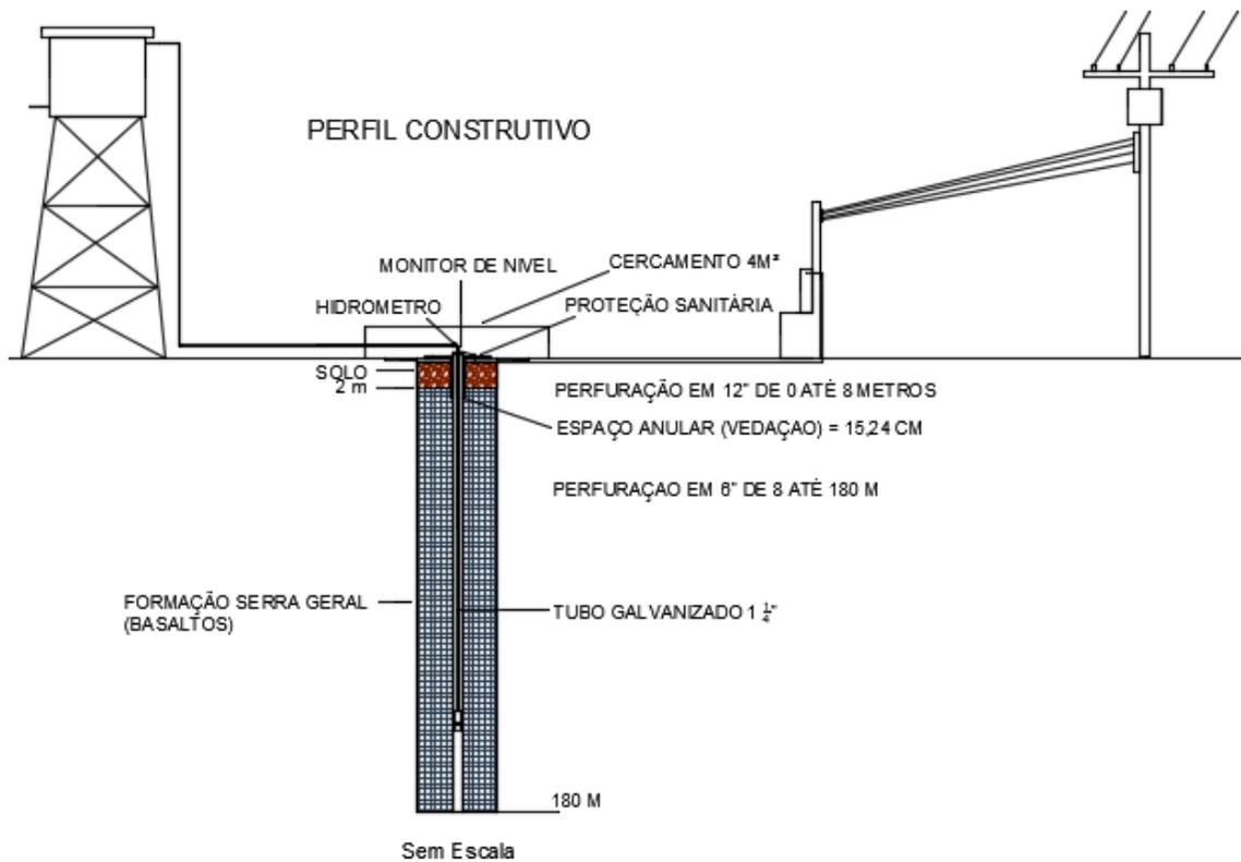
Figura 13: Perfil Construtivo do Poço. Fonte: Autor (2022).
