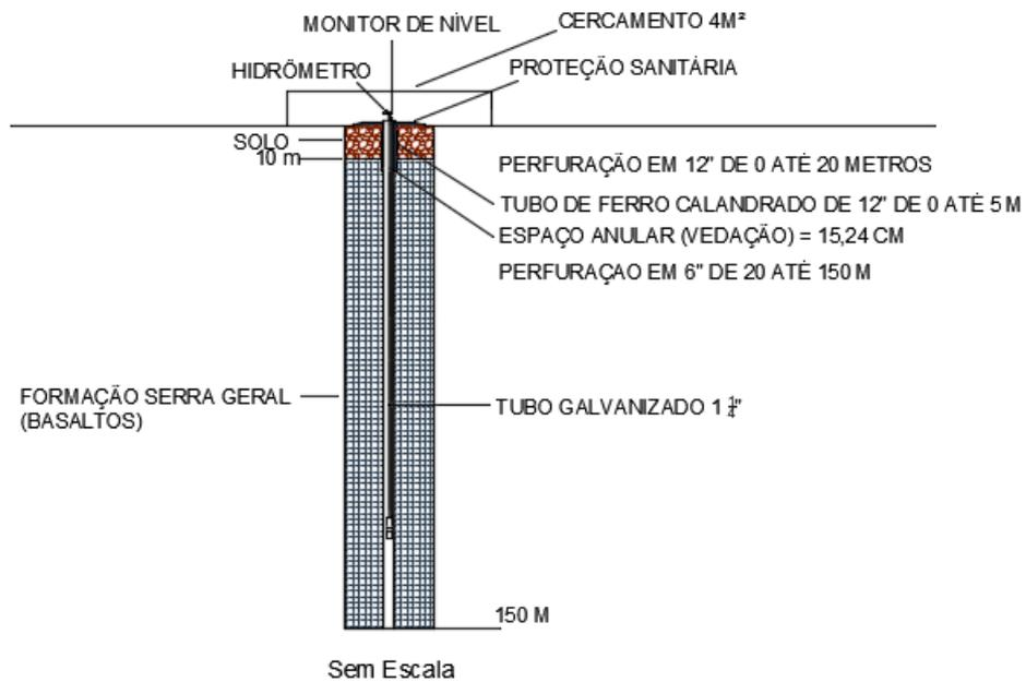
Figura 14: Perfil Construtivo do Poço. Fonte: Autor (2024).
